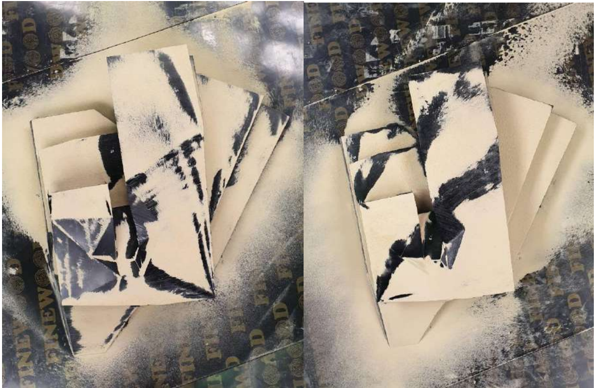
Рисунок 3.66– Характерные зоны снеговых отложений, углы набегающего потока 0^{\circ} (С) и 270^{\circ} (В)
