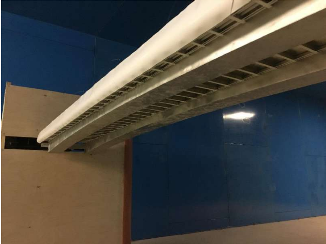
Рисунок 5.13– Модель пролетного строения моста (сплошной экран). Вид снизу
