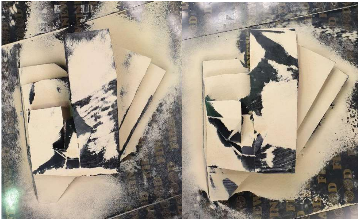
Рисунок 3.66– Характерные зоны снеговых отложений, углы набегающего потока 0^{\circ} (С) и 270^{\circ} (В)
