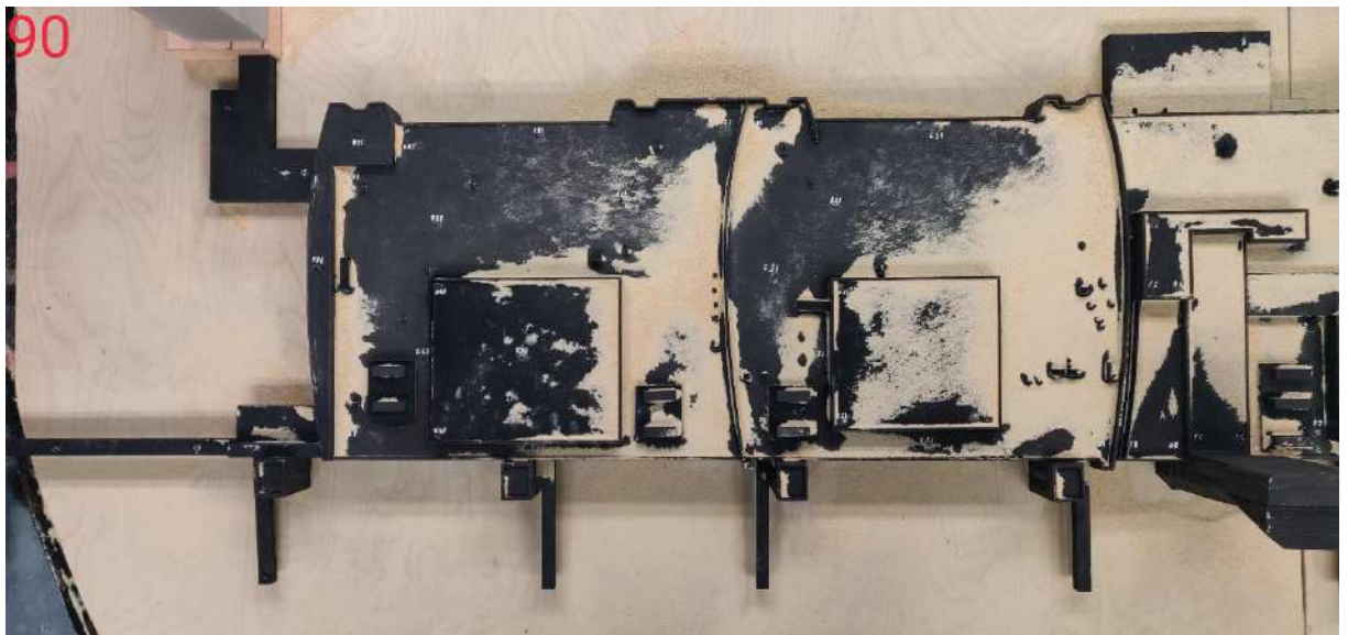
Рисунок 3.71– Характерная картина снегопереноса, угол набегающего потока 90^{\circ} (Терминал А)
