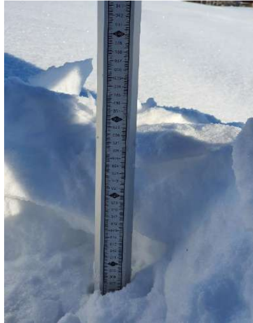
Рисунок 4.20– Измерение толщины снегового покрова
