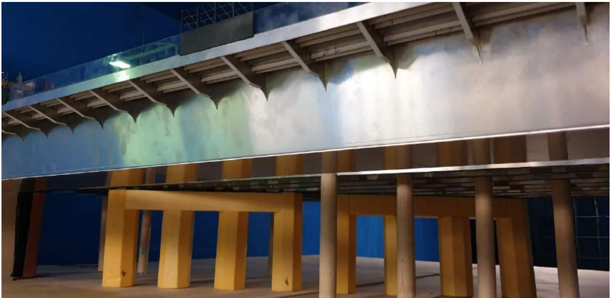
Рисунок 3.9 – Отсечная модель пролетного строения (вид снизу)
