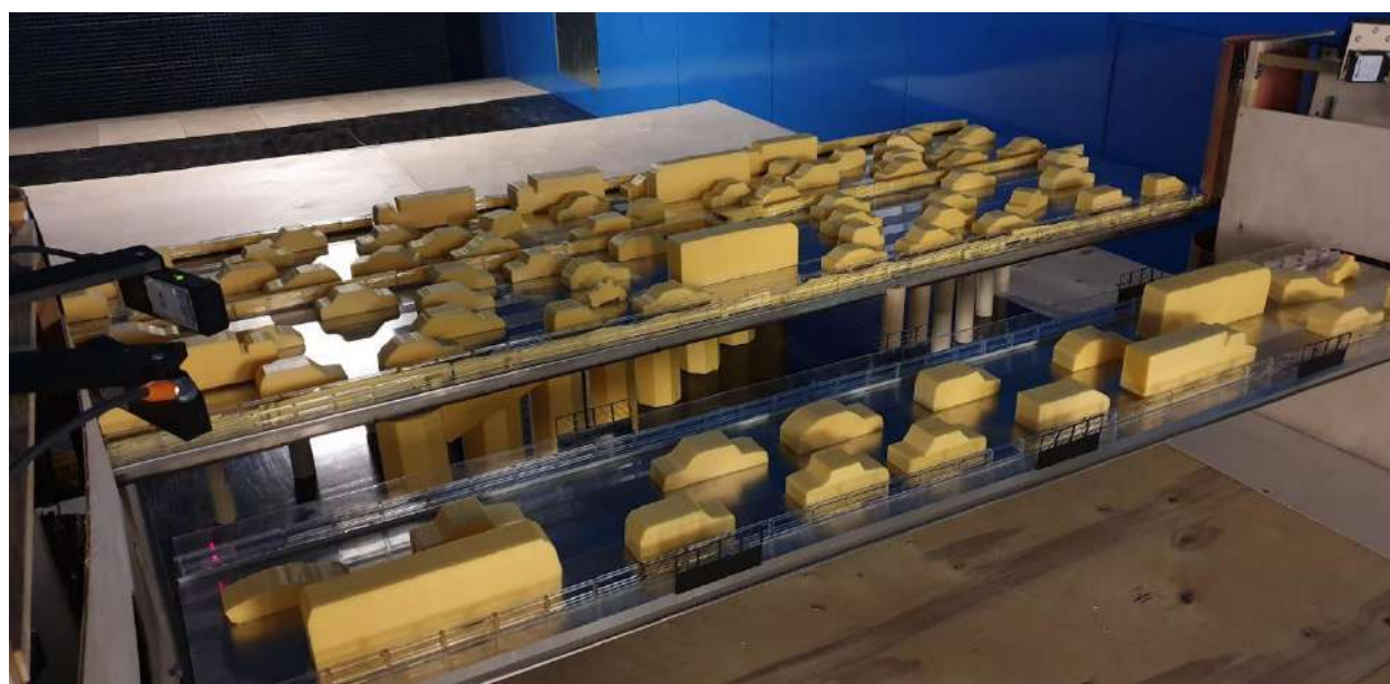
Рисунок 3.31– Оценка влияния автомобильного трафика на аэродинамическую устойчивость
