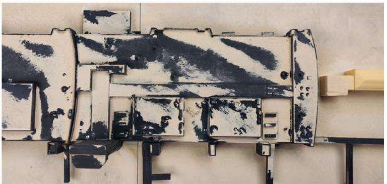
Рисунок 3.73– Характерная картина снеготеноса, угол набегающего потока 45^{\circ} (Терминал В)
