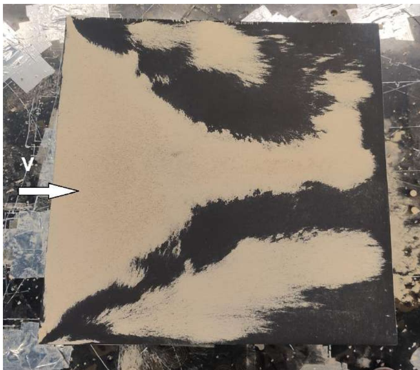
Рисунок 4.14— Модель с карнизом и конструктивной толстой передней кромкой после экспозиции в потоке
