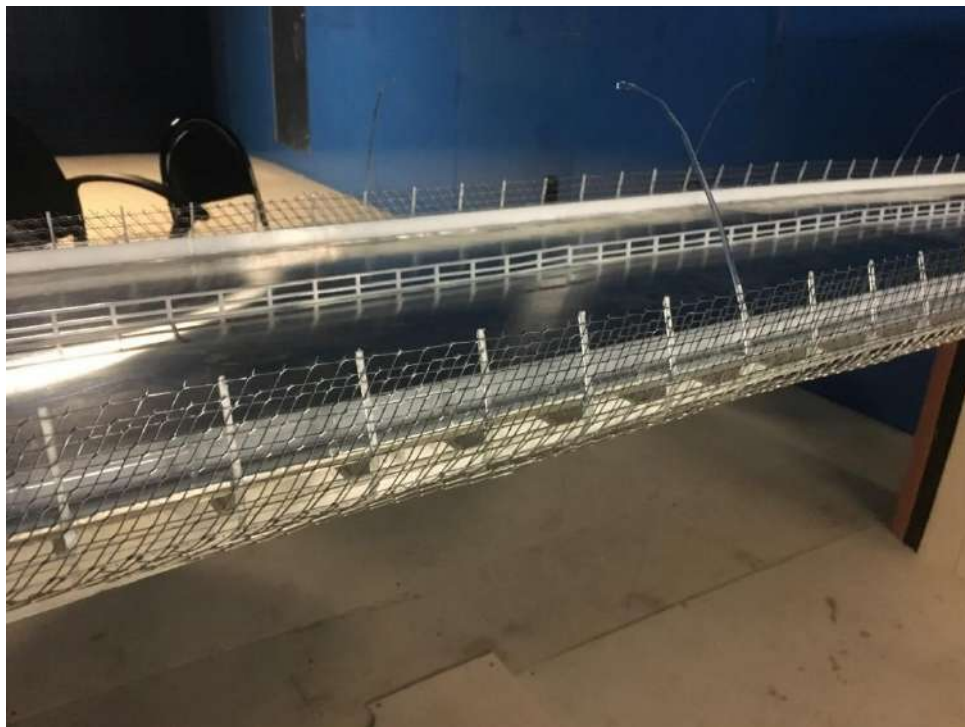
Рисунок 5.14 – Модель пролетного строения моста (проницаемый экран). Вид сверху
