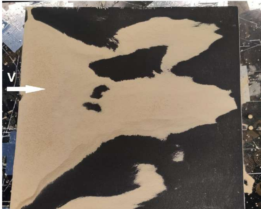
Рисунок 4.12– Результат продувки модели с карнизом (толстый слой)
