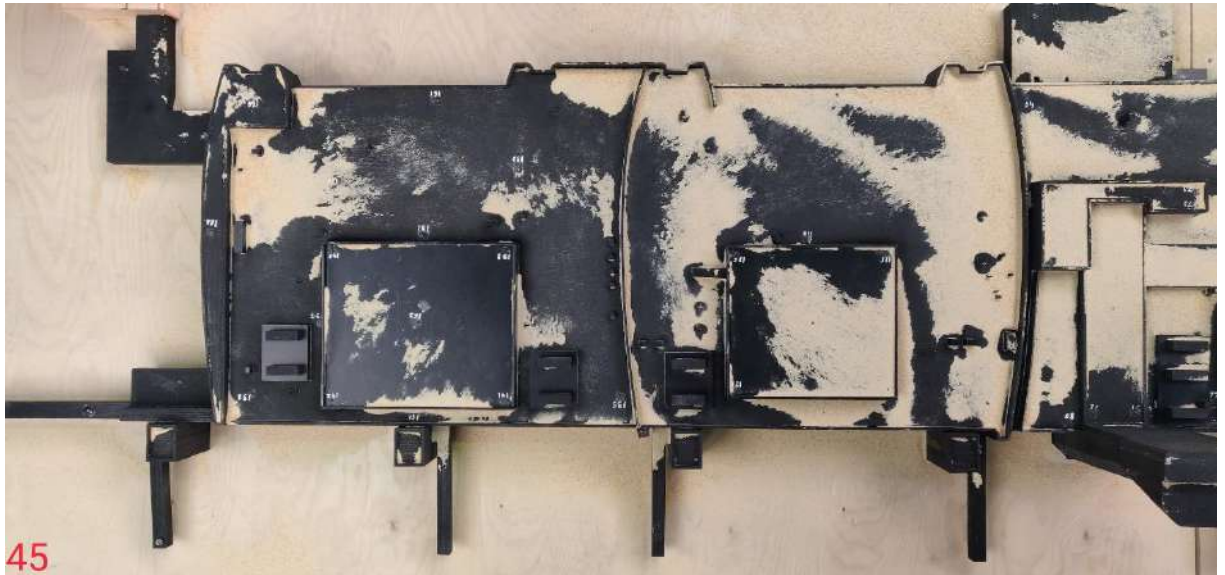
Рисунок 3.70– Характерная картина снегопереноса, угол набегающего потока 45^{\circ} (Терминал А)
