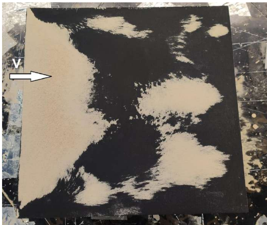
Рисунок 4.11– Результат продувки модели с карнизом (тонкий слой)
