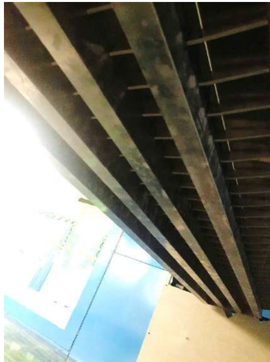
Рисунок 3.25– Отсечная модель пролетного строения (вид снизу)
